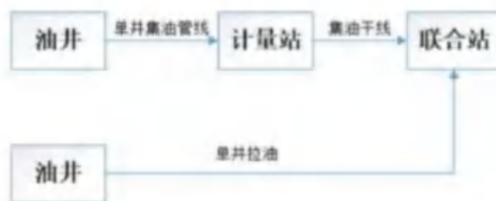
图 3-25 采油工艺流程及产污环节
