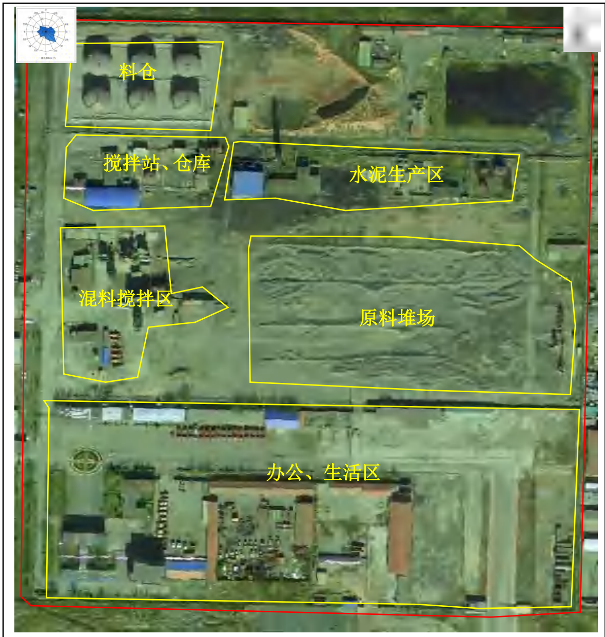
图 3-23 水泥制品厂厂区平面图（2008 年 2 月影像）
